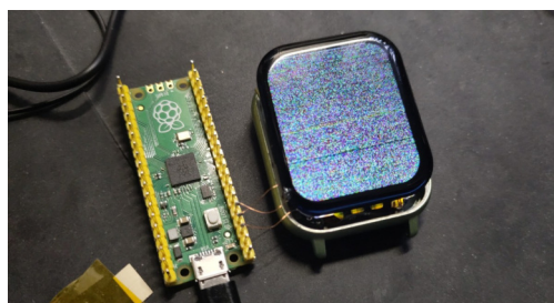
Fig. 2. Installation matérielle de capture des données envoyées à l'écran de la montre.
