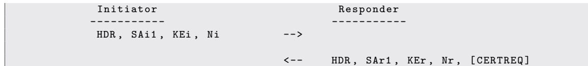
Fig. 10. Phase initiale IKEv2 (source : RFC 4306)
